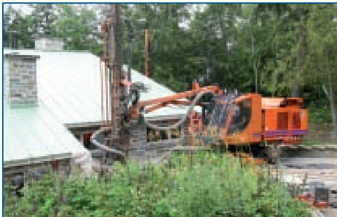
De nouvelles foreuses géothermiques ont été développées à partir des équipements utilisés pour creuser des trous de dynamitage dans les travaux de voirie. Elles fonctionnent selon le même principe que les perceuses à percussion.
